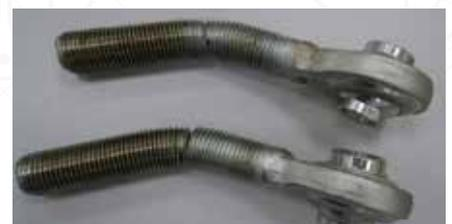
» Biegeprüfung an den Oberlenkerspindeln bis zum Biegewinkel von ca. 30°
